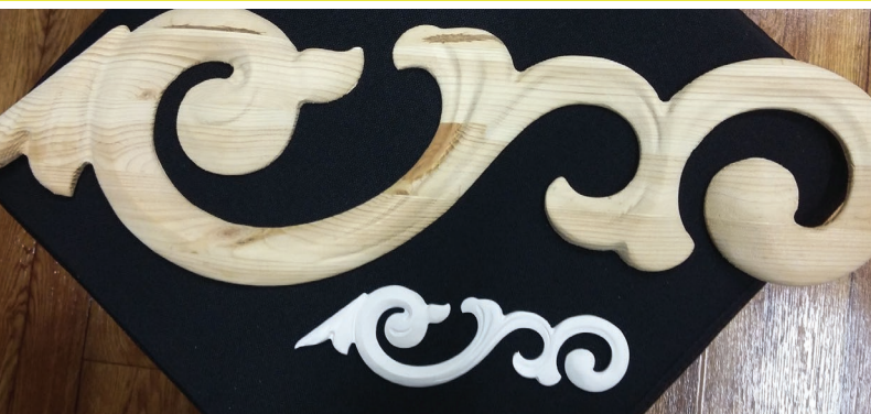
Skaneeritud ornament, millest on valmistatud 3D-fail ja CNC-l tehtud suurendatud koopia.
