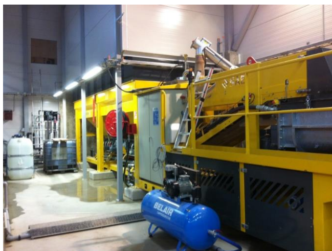
Pilt 7. Stabiliseerimisseade Vaivaras Allikas: KIK (Projekti Vaivara ohtlike jäätmete käitluskeskuse nõrgvee ja saastatud sademevee puhastussüsteemi parendamine maksumus 2,5 milj eurot. Toetuse määr 100%)
